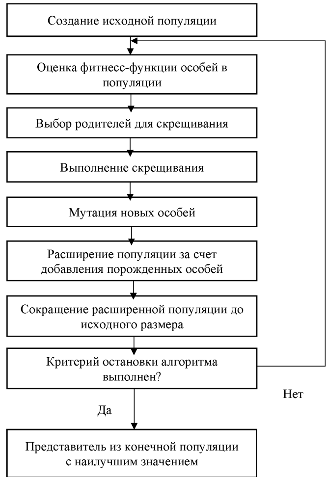
Рис. 1. Механизм действия генетического алгоритма Источник: Составлено автором на основе источников: [1], [15]
