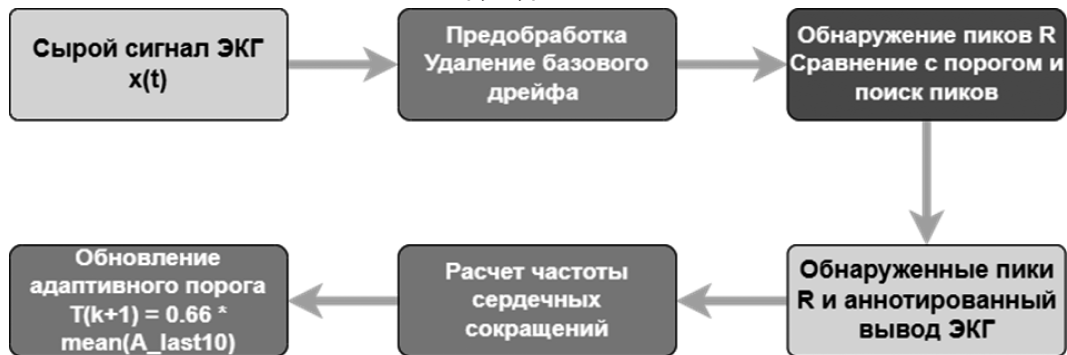
Рис. 3. Общая схема работы алгоритма обнаружения R-волн
