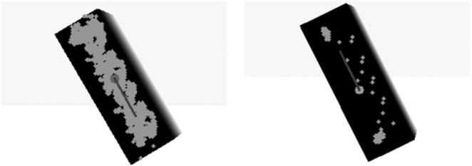
Рис. 5. Графическая интерпретация отсеечения точек с вероятностью захвата выше 0,5 слева и 0,9 справа (серые точки), центром массы объекта (светло-серая точка) и главной компонентой (темно-серая линия)
