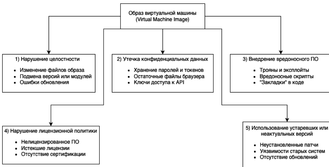
Рис. 2. Диаграмма классификации угроз безопасности образов виртуальных машин
