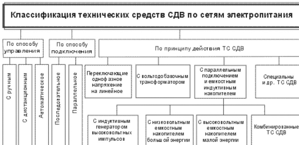
Рис. 2. Классификация технических средств СДВ по сетям электропитания.
