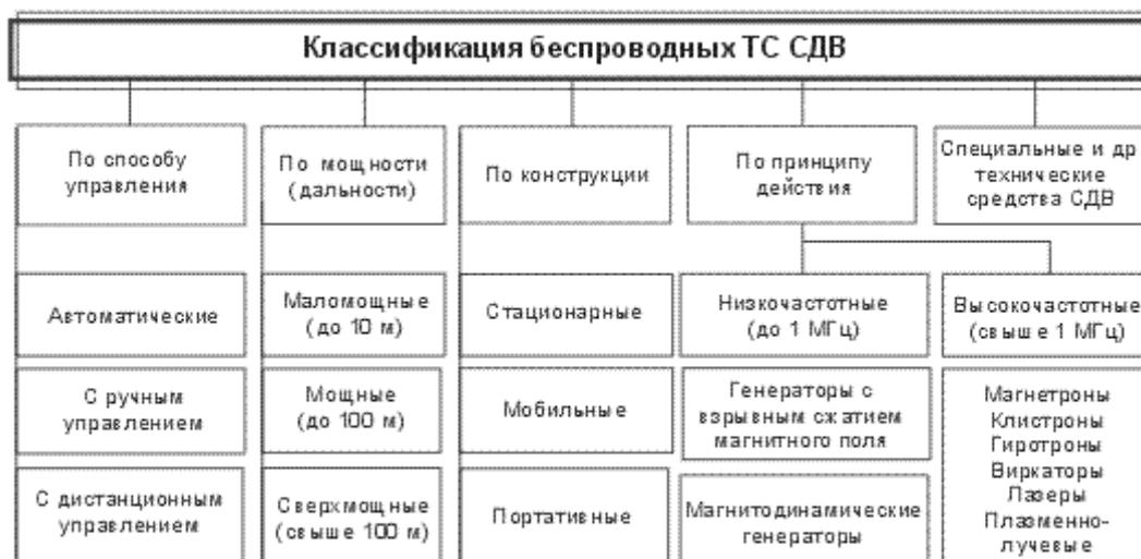
Рис. 5. Классификация беспроводных ТС СДВ.
