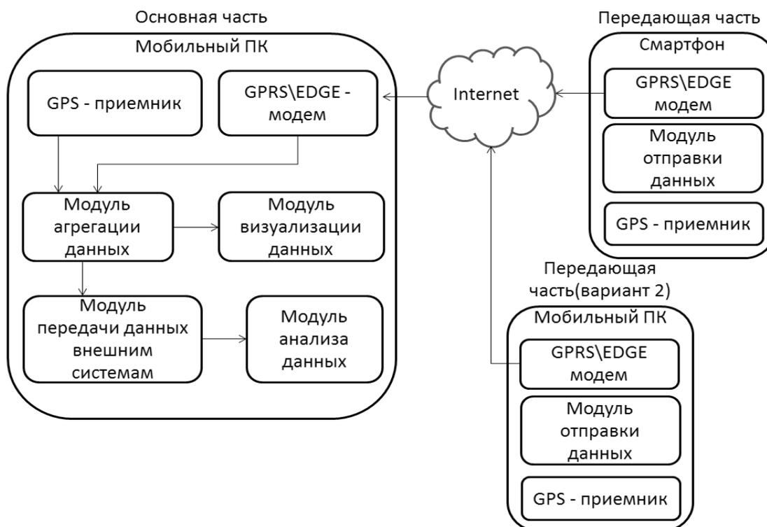
Рис. 1. Схема программно-аппаратного комплекса наблюдения за надводными объектами
