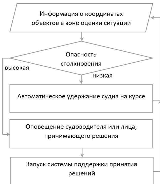
Рис. 2. Алгоритм работы интеллектуального автопилота с расширенным функционалом
