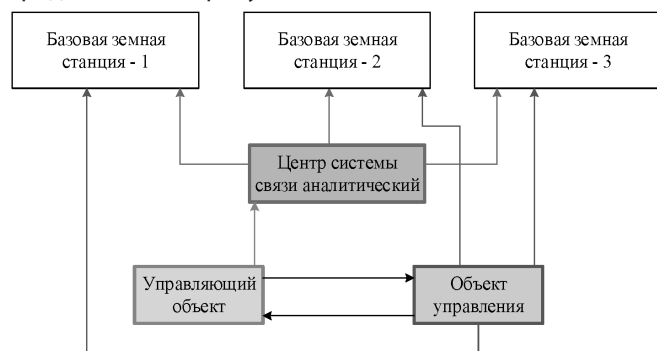
Рис. 1. Структурная схема системы управления наземной ИТКС среднеорбитальной системы спутниковой связи «СКИФ»
