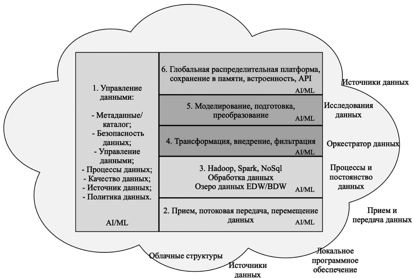
Рис. 2. Типовая архитектура цифровой фабрики данных [7]
