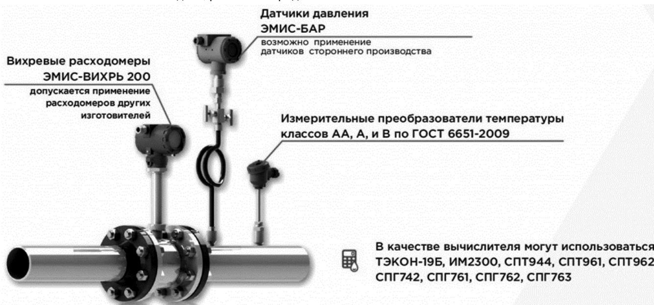
Рис. 3. Состав автоматической системы контроля газовых котельных
