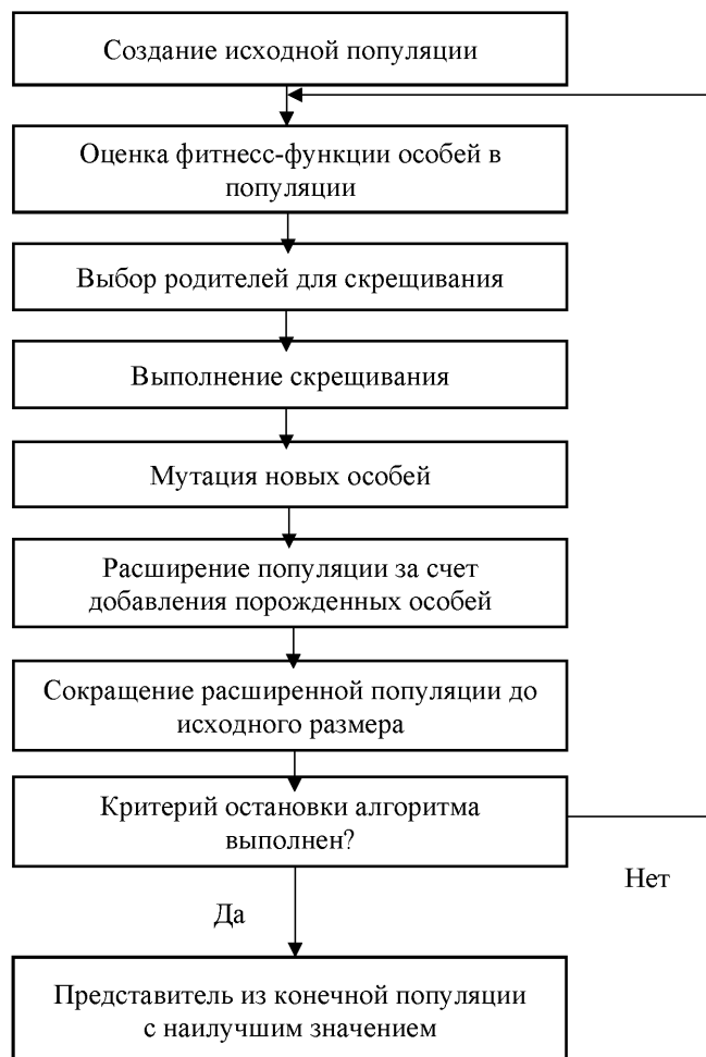
Рис. 1. Механизм действия генетического алгоритма Источники: Составлено автором на основе источников: [1], [15]
