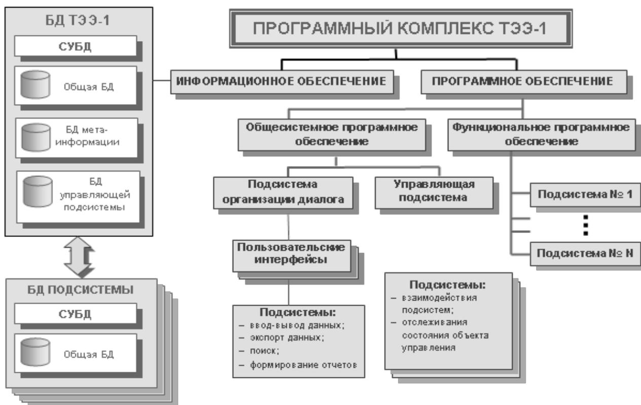
Рис. 2. Общая структура программного комплекса ТЭЭ-1
