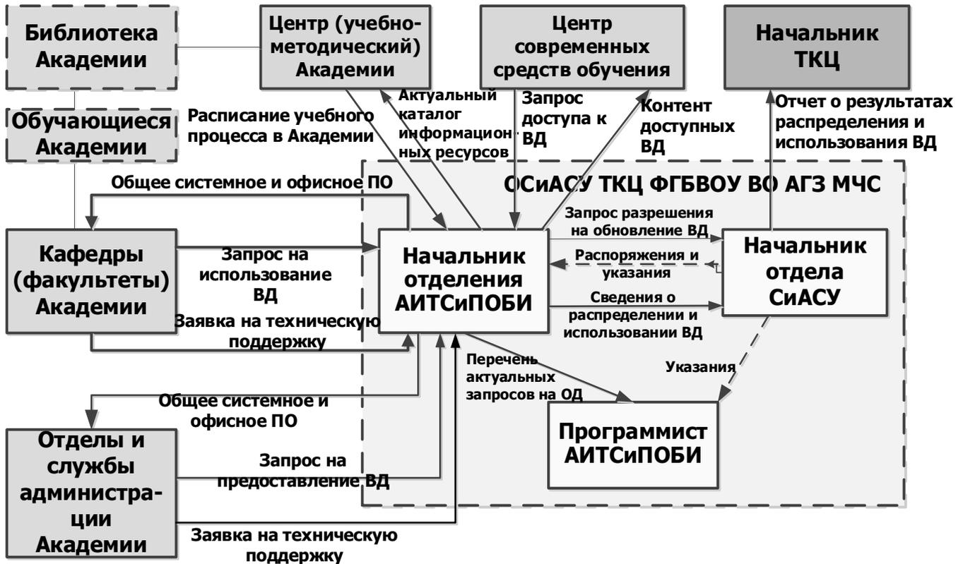
Рис. 4. Схема информационных потоков в АИТСИПОБИ, связанных с обработкой, хранению и использованию ВД в вычислительных комплексах и компьютерной сети в Академии
