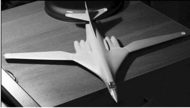
Рис. 7. Геометрическая копия в масштабе реального ЛА
