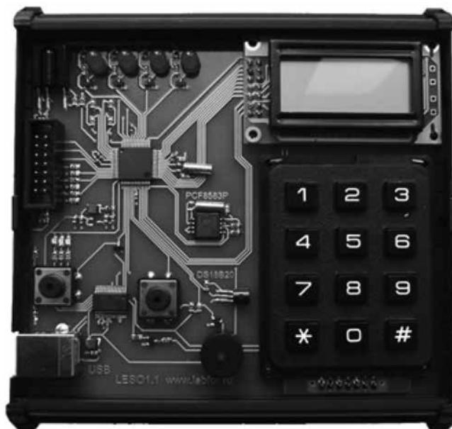
Рис. 1. Внешний вид учебного лабораторного стенда
